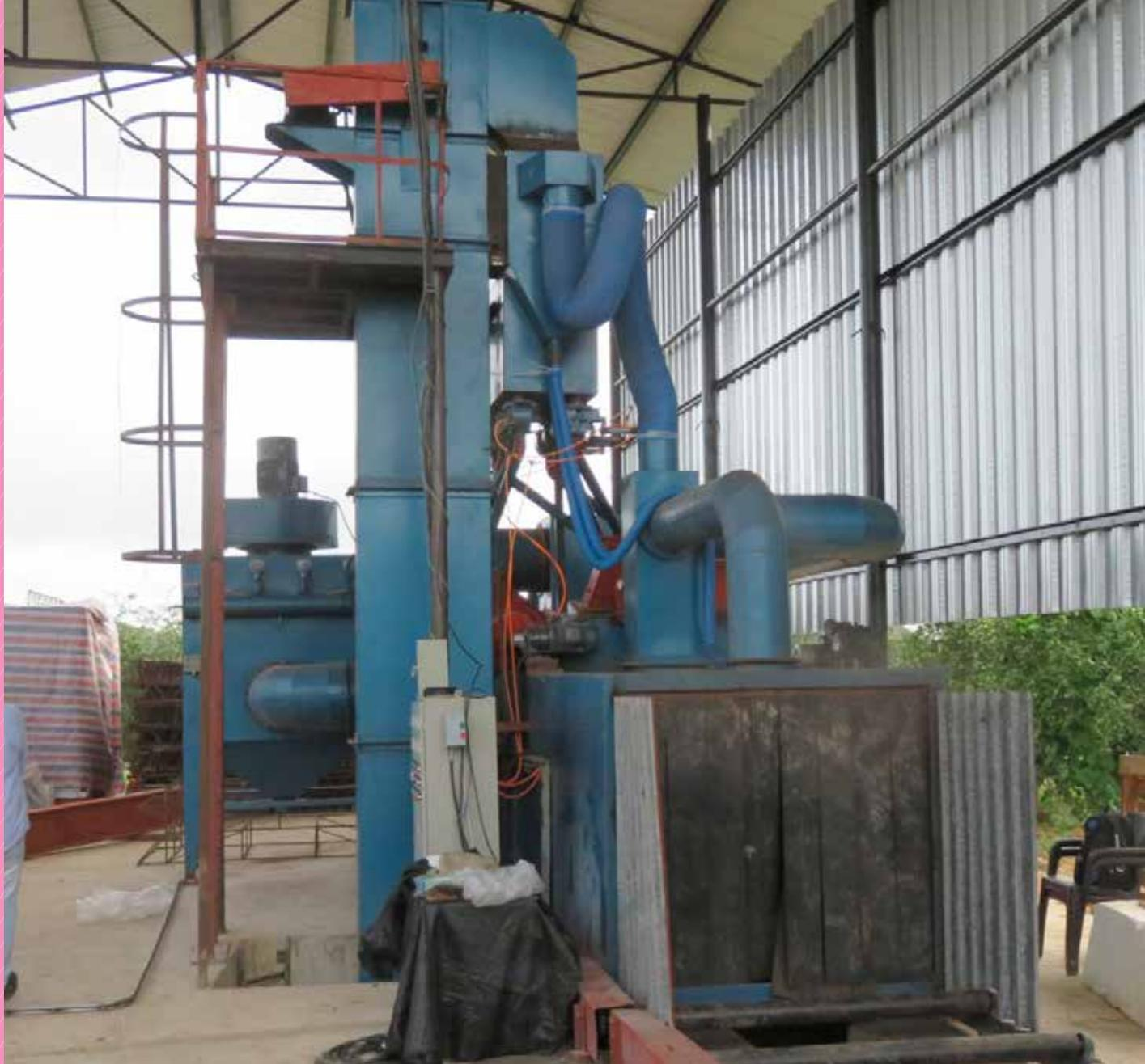
Granalladora automatizada con 8 turbinas para la limpieza de elementos metalicos, tales como: perfiles, láminas, estructuras, equipos para construcción como cerchas, parales y andamios.
